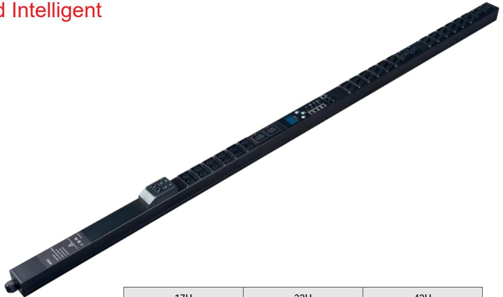
Контролируемая IP панель распределения питания на 24 гнезда IEC 320 (20xС13 + 4xС19), с дисплеем, ZeroU, алюминиевый корпус, 2x16А гидравлических автоматических выключателя, 8000 W, 250V AC, 3x6.0мм2, шнур 3м с вилкой IEC60309 (32А 2P+E), дистанционный контроль
