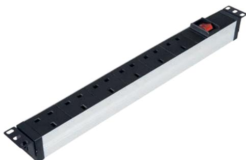
19" Блок розеток BS1363 английский стандарт на 6 гнезд, алюминиевый профиль 1U, 16A выключатель, 4000 W, 250V AC, 3x1.5мм2, шнур 2,5м
