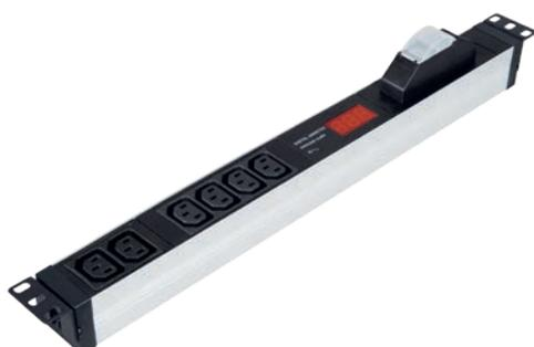
19" Блок розеток IEC 320 C13 на 6 гнезд, с амперметром, алюминиевый профиль 1U, 1x16A автомат. выключатель, 4000 W, 250V AC, 3x2.5мм2, шнур 3м вилка IEC60309
